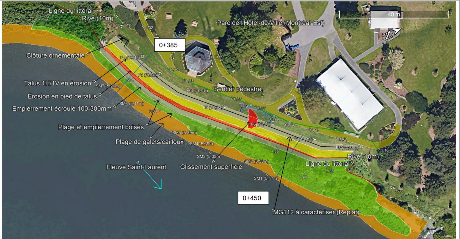
Deux profils fait pour représenter l'ensemble de l'ouvrage. Un premier au site approximativement le plus large (vers le chainage 0+385) et un autre au site moins large (au chainage 0+450).
